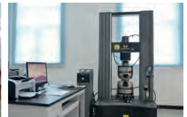
美国INSTRON电子万能材料试验机 American INSTRON electronic material testing machine
