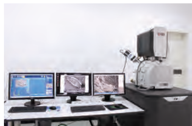
美国FEI场发射扫描电子显微镜 American FEI field emission scanning electron microscope
