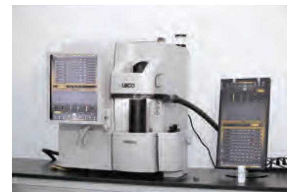
美国LECO氧氮氢分析仪 American LECO Oxygen, Nitrogen and Hydrogen Analyzer
