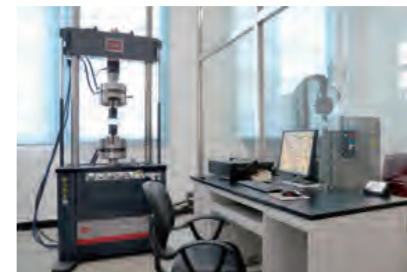
美国MTS低频疲劳试验机 American MTS low-frequency fatigue testing machine
